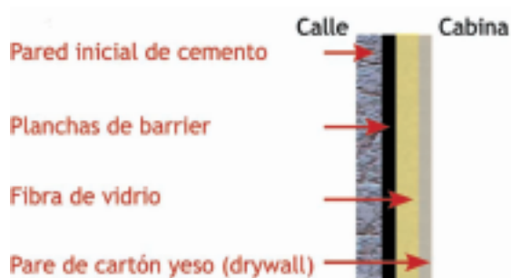
[83] Diferentes capas para la insonorización
